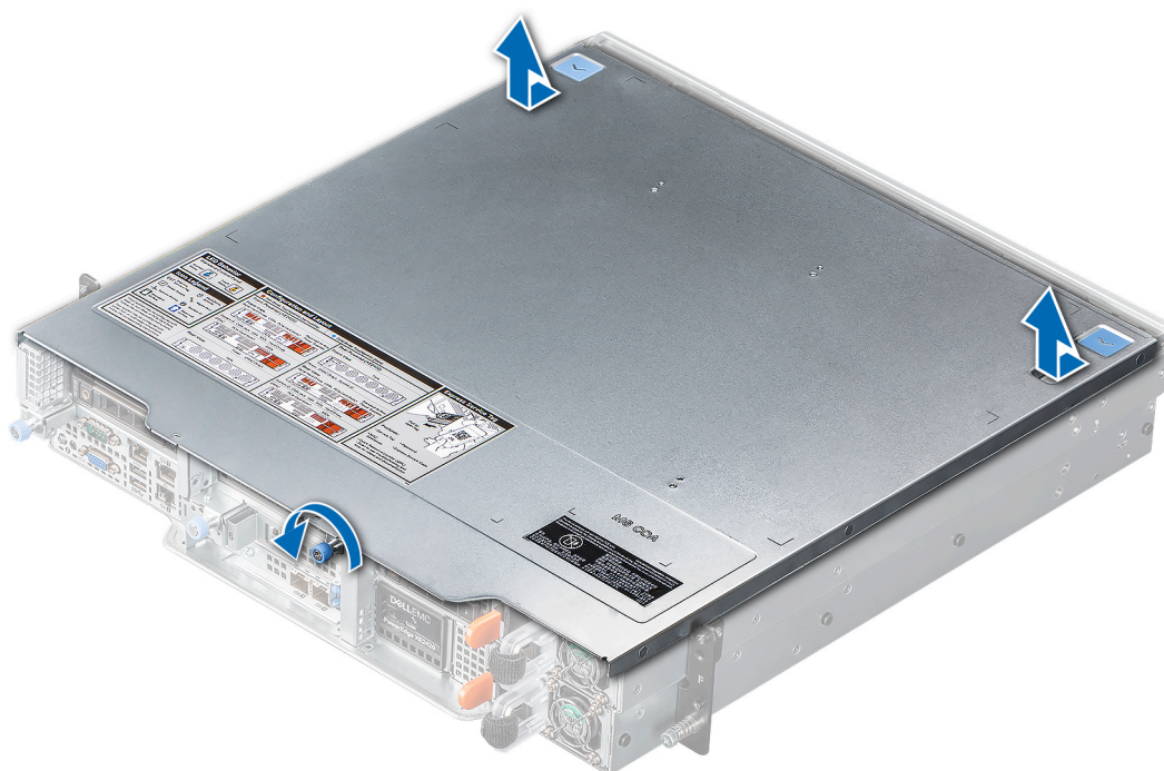
Ilustración 33. Extracción de la cubierta del sistema
