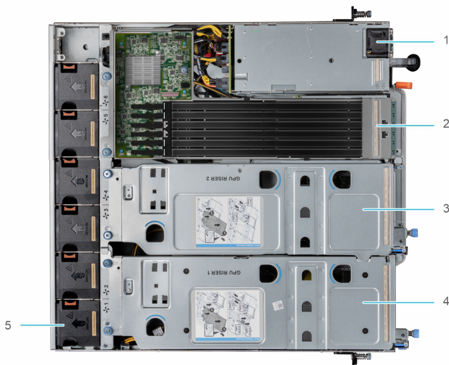
Ilustración 7. Interior del sistema de 6 x EDSFF
