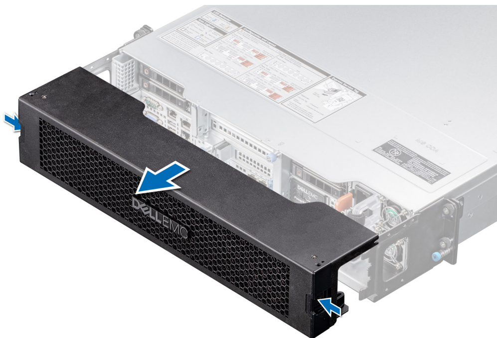
Ilustración 27. Extracción de la cubierta del bisel frontal
